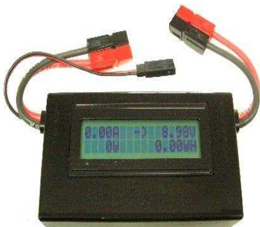
Figure 8 : Système de mesure de tension, de courant et de puissance qui s'insère dans une ligne équipée de connecteurs Powerpole
