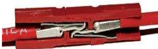
Figure 3 : Vue en coupe montrant les contacts et les ressorts assurant la pression de contact
